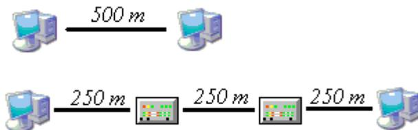
**Le Gigabit Ethernet** (1000 BaseT) qui permet de transporter de l'information à la vitesse de 1000 Mbits/s ( 1000 millions de bits par seconde ) par câble ou fibre optique, est une évolution récente de l'Ethernet, l'augmentation de la vitesse de transmission réduit drastiquement la distance maximale théorique d'éloignement de deux machines avec un même câble à environ 50 m et à quelques mètres si elles sont connectées par des Hub.
